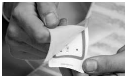
Slika 2. RFID u obliku samolepljive etikete
