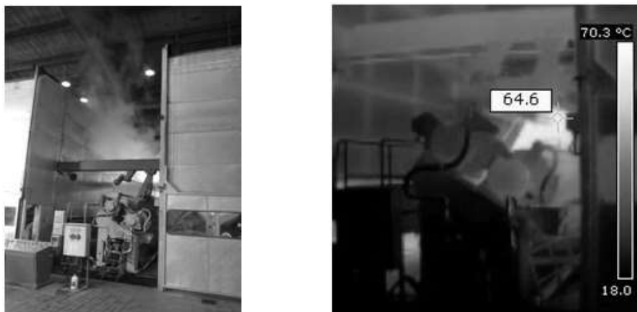
Slika 6. Gubici toplote sa papir mašine u prostor proizvodne hale kod lajm prese
