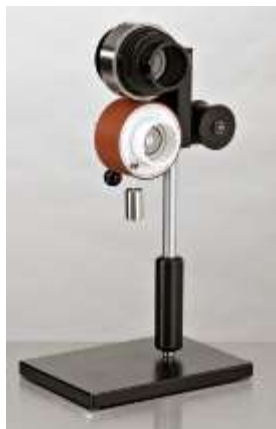
Slika 5. Držalac čeličnog valjka na postolju u kontaktu sa gumenim valjkom
