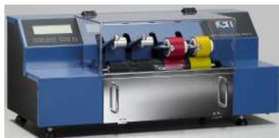
Slika 3 Uređaj za bojenje valjaka za izradu probnih otisaka
