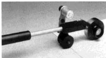
Slika 4. Držalac čeličnog valjka tokom kotrljanja po površini papira ili kartona koji se ispituje
