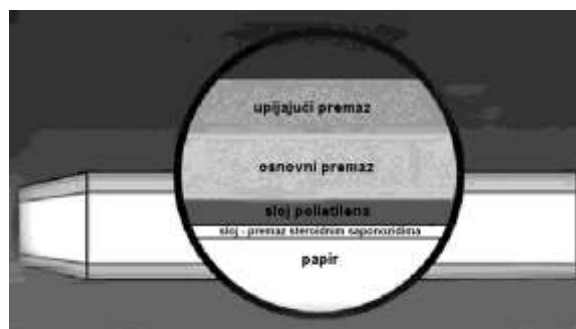
Sl.5. Premaz steroidnim saponozidima prije ostalih slojeva
