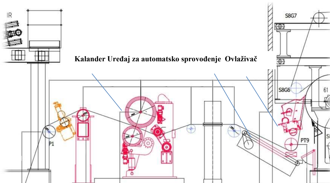
Slika 3: Šematski prikaz kalandera, uređaja za sprovođenje kartonske trake i ovlaživača
